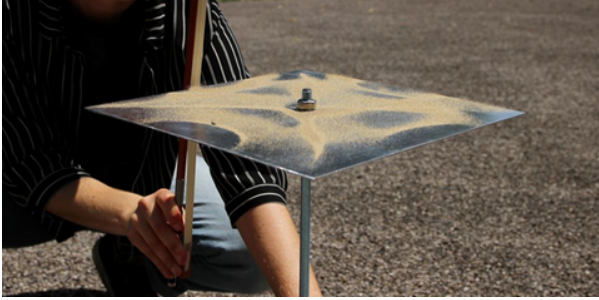
Abbildung 5. Schwingungsmuster in der Ebene und die verschiedenen physikalischen Modi illustriert die mit Sand bestreute Chladni-Platte, wenn man sie mit dem Geigenbogen streicht. Ausstellungsstück von Carina Nunweiler.
