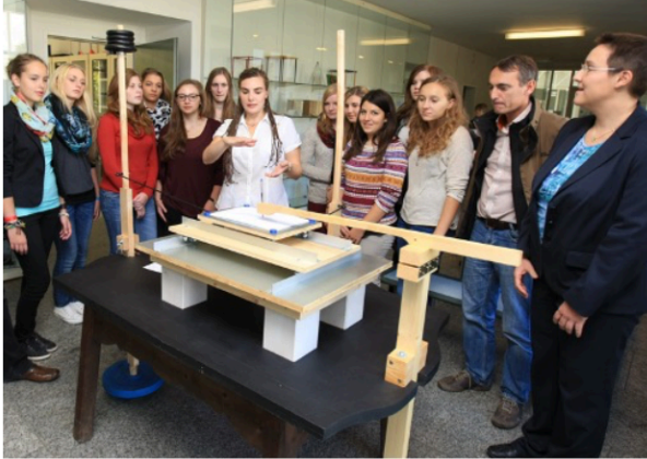
Abbildung 10. Die Lissajous-Maschine, gebaut mit schweren 15 kg Gewichten für eine lange und stabile Bewegung. Zwei in orthogonalen Ebenen schwingende Pendel treiben zwei übereinander liegende Rollbretter an, auf welchen obenauf ein Blatt Papier befestigt ist. Ein feststehender Stift macht die Bewegung der Rollbretter sichtbar. Exponat von Linda Rank (Mitte).
